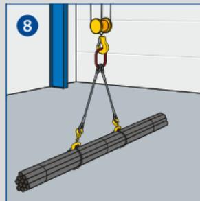
**Last so anschlagen, dass sie beim Heben nicht pendelt, schrägzieht oder rausrutscht.**
