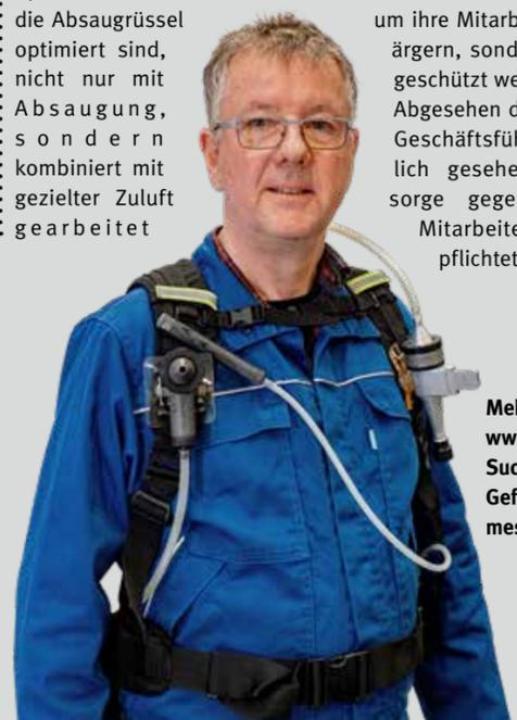
Olaf Binder demonstriert, wie das Mess-Equipment vor Ort von Mitarbeitenden getragen wird: Die Probenahmeköpfe und Pumpen werden mit Hilfe eines speziellen Gurtsystems und mit Clips an der Person befestigt. Je nach sitzender oder stehender Tätigkeit können diese in unterschiedliche Schlaufen eingehängt werden. Die Pumpen befinden sich oft am unteren Rücken oder an der Seite (im Bild nicht sichtbar), damit sie nicht bei der Arbeit stören.
