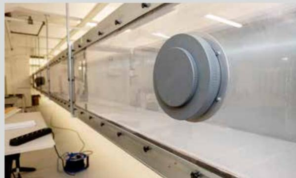
In den langen Staubkanal wird staubige Luft eingeblasen und dann auf dem Weg in seinem Verhalten untersucht. Dafür gibt es verschiedene Entnahmepunkte. Hier wird geprüft, ob die Staubkonzentration gesunken ist.
