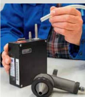
Über einen Schlauch wird der Probenahmekopf samt Filter mit der Pumpe verbunden.
