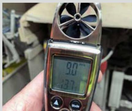
Das Messgerät zeigte anfangs eine Strömungsgeschwindigkeit von 9 m pro Sekunde. Mit ein paar einfachen Maßnahmen konnte diese auf über 30 m pro Sekunde erhöht werden.
