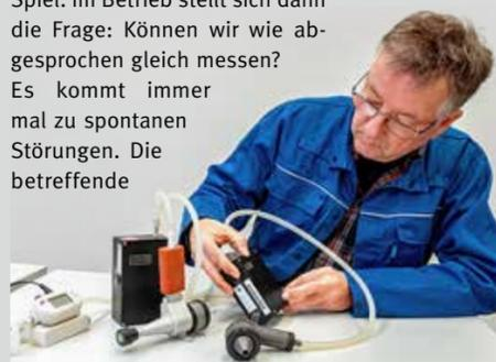
Vor dem Start der Messung wird an jedem Messsystem geprüft, ob die vorgeschriebene Luftmenge stimmt, welche von der Pumpe angesaugt wird.
