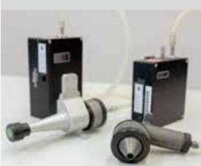
Das linke Messsystem ist mit einem A-Staubfilter ausgestattet, es misst den feinen, alveolengängigen Staubanteil. Das rechte System erfasst den Gesamtstaub.
