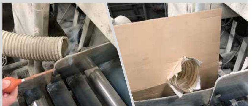
Die Qualmwolke aus dem Prüfröhrchen zeigt das Strömungsverhalten in der Nähe der Absaugung. Im Originalzustand ist die Wirkung gleich null. Die Luft wird nicht eingesaugt.
