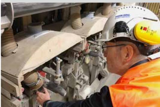
Thomas Körner vom Messtechnischen Dienst der BG RCI platziert das Strömungsmessgerät am Absaugrohr. Rechts daneben befindet sich der Abfüllstutzen, über den ein Sack gestülpt und dann Trockenmörtel reingeblassen wird.
