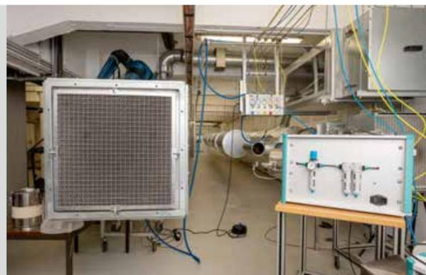
Im Testzentrum des IGF befinden sich 22 m lange Staubkanäle, in denen konstante Staubkonzentrationen erzeugt und untersucht werden.
