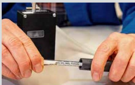
Bei Messungen von Gasen, z. B. Aceton, werden mit Silicagel oder Aktivkohle gefüllte Glasröhrchen als Probeträger genutzt.
